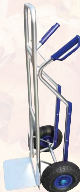
cod. C1299010 CARRELLO TRASPORTO PACCHI IN ALLUMINIO e gomma, portata max 150 kg, ruote pneumatiche 10" . Dimensioni: cm 48x49xH117
