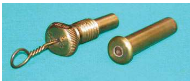
Sistemi d'accensione per artiglieria da 149: a sinistra cannello a vite, a destra petardetto a percussione
